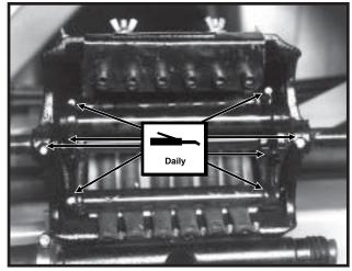
Squeeze Pump - 8 Zerks Per Pump
