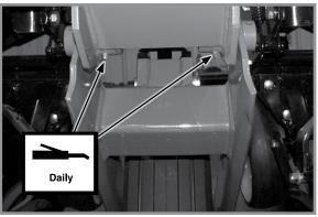
2. Wheel pivots - 2 per wheel module
