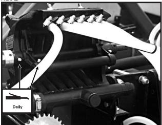
Squeeze Pump - 8 Zerks Per Pump
