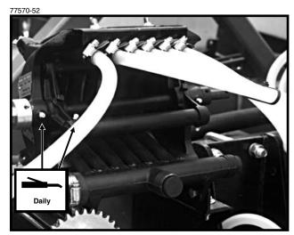
Squeeze Pump - 8 Zerks Per Pump
