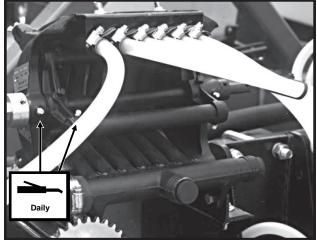
Squeeze Pump - 8 Zerks Per Pump
