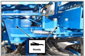
14. 36 Row bulk fill catwalk extension pivots (2)
