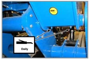
1. Wheel modules, 8 per machine 2 fittings per module
