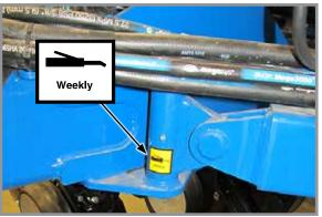
5. Draft Link, 2 per machine 1 fitting per link
